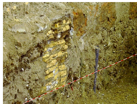
Odkopané teleso soilcretu s naznačenou HPV
